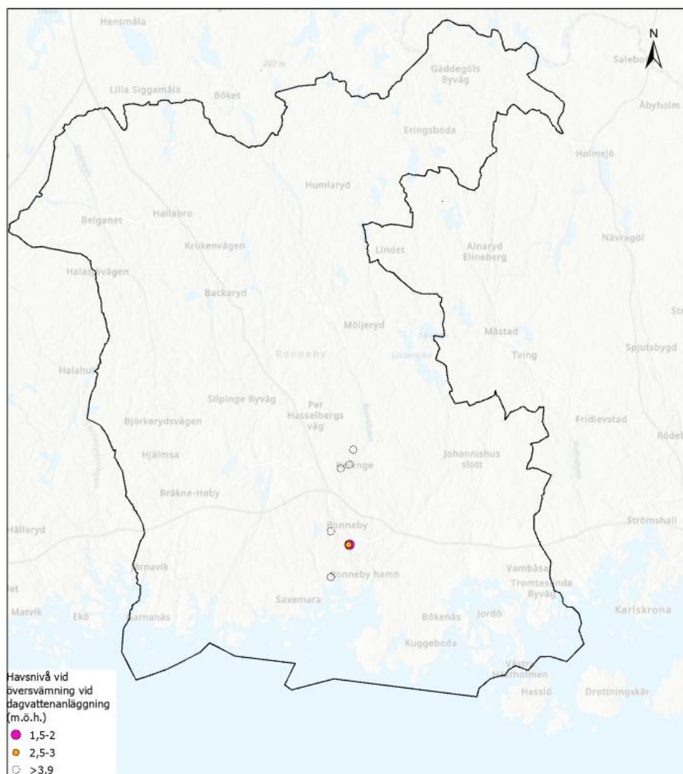
Figur 25. Översvämmade dagvattenanläggningar vid höga havsnivåer.
