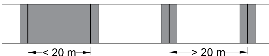
Figur 2 Exempel på asfaltering i skadad yta
