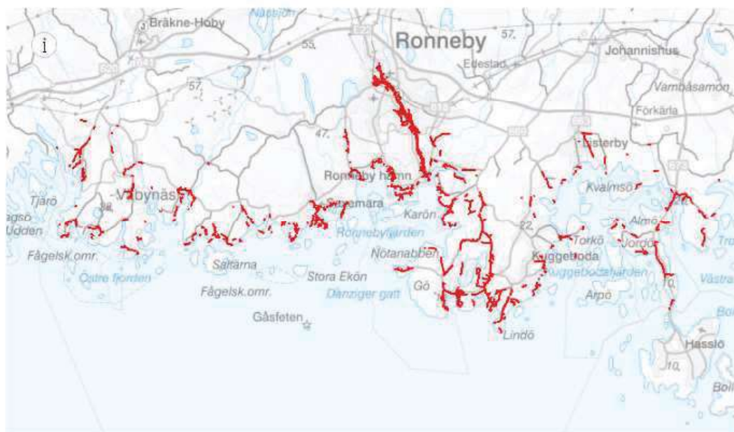
Vägar som påverkas negativt av stigande havsnivåer på 3,9 meter markeras i rött.
