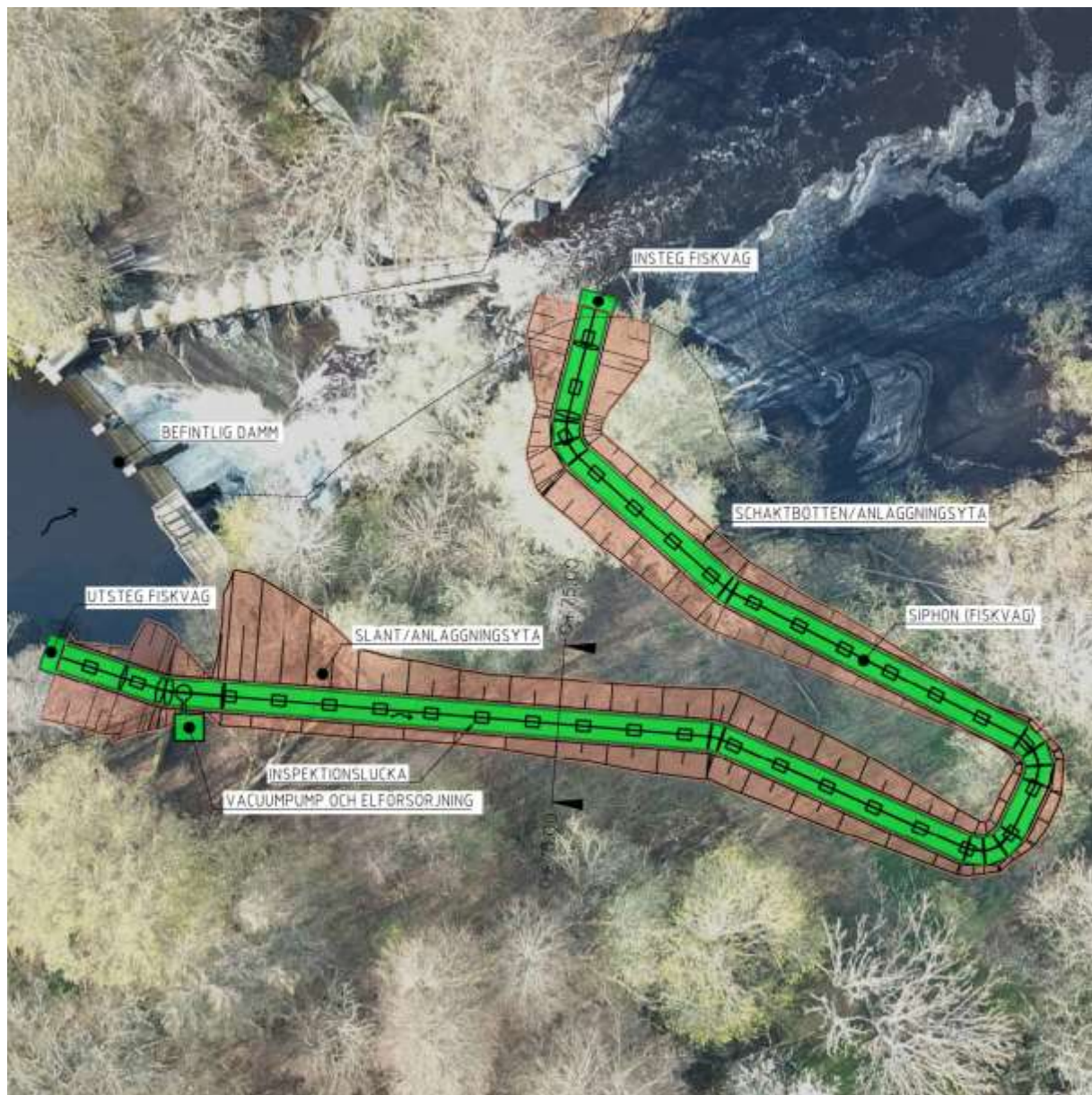
Figur 3 - Förslag till placering av Siphon-fiskväg vid Snittingedammen
