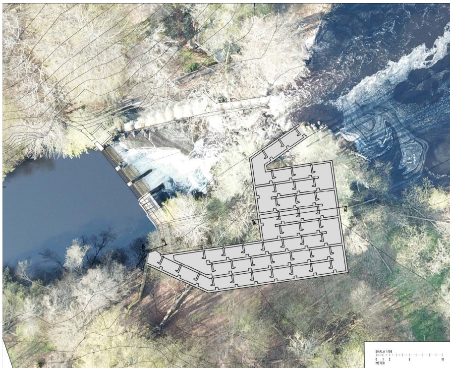
Figur 8. Planritning över slitstrappa längs höger strand.
