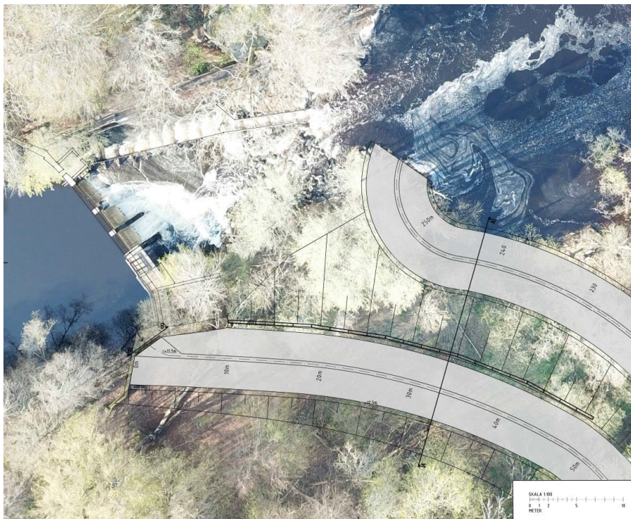
Figur 5. Planritning över fiskvägens in- och utsteg.
