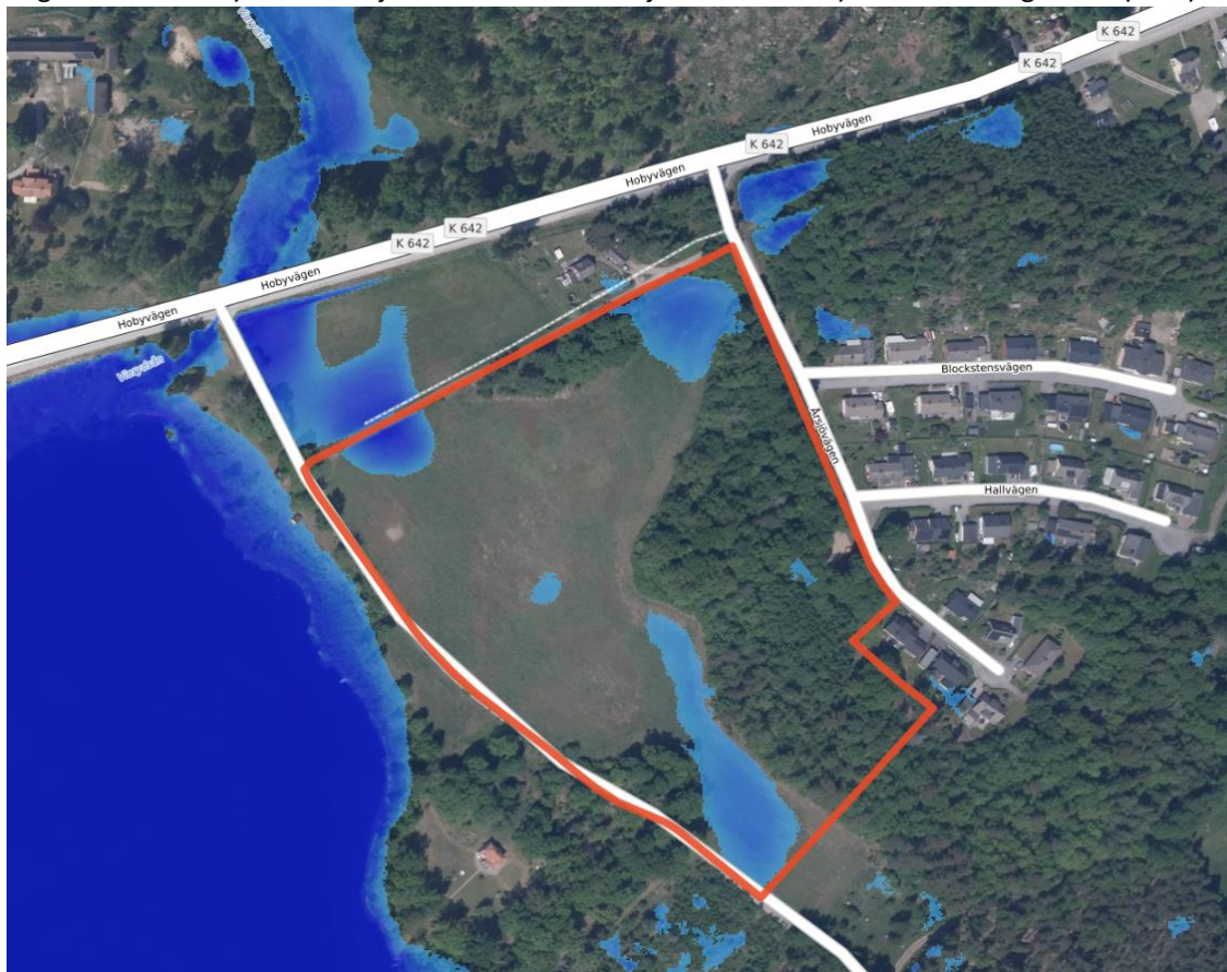
Figur 10 100 mm regn pålagt i SCALGO Live för att visa utbredning av Årsjön vid 100-års regn. Planområdesgräns i rött.
