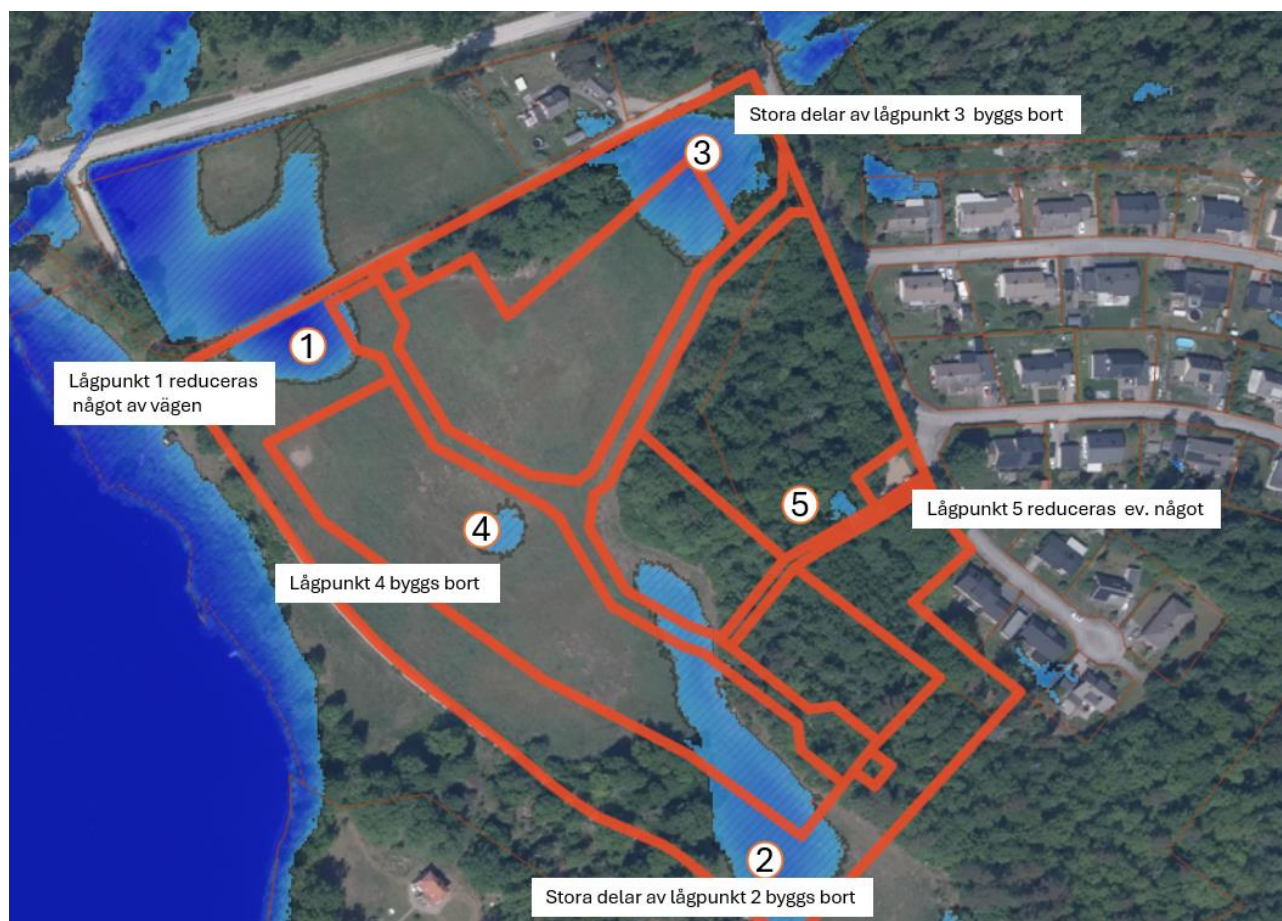
Figur 14 Befintliga lågpunkter som påverkas av exploatering 10 cm regn pålagt i SCALGO Live
